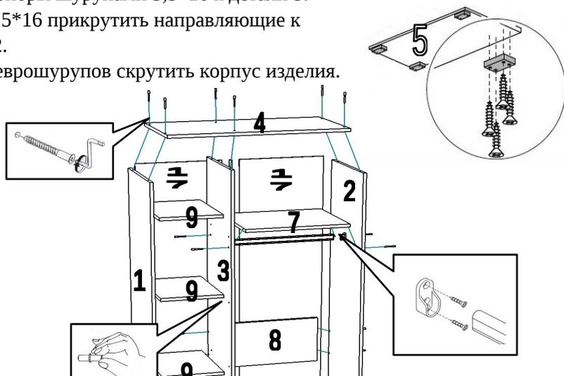
Прибить гвоздями задние стенки ЛДВП, предварительно измерив диагонали. Для соединения 2х полотен ЛДВП используйте брус соединительный.
