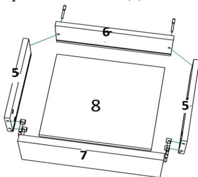
Еврошурупами скрепить детали 5 и 6, в пропил вставить ЛДВП. В готовые отверстия детали 7 ввернуть эксцентрики и закрепить фасад на корпус ящика стянув замками. К нижней части ящика привернуть шурупами 4\*16 направляющие колесом назад. Вкатить ящик в корпус тумбы.
