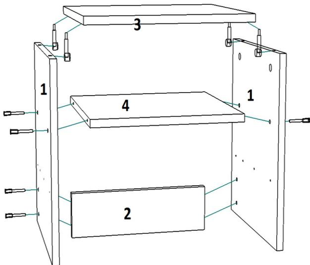
К боковине 1 гвоздями прибить подпятники и шурупами 4\*16 привернуть направляющие колесом вперед. Еврошурупами скрутить детали 1, 2 и 4, как показано на рисунке. В готовые отверстия детали 3 ввернуть винты эксцентриков и установить крышку на боковину, стянув замками.
