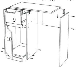
устанавливая планки 4 и 5, как показано на рисунке. В готовые отверстия детали 1 ввернуть эксцентрики и скрепить замками с деталями 2. Предварительно
