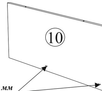
Просверлить отверстия диаметром 3 мм
