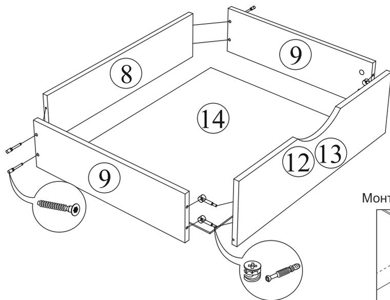
Монтаж эксцентриковой стяжки
