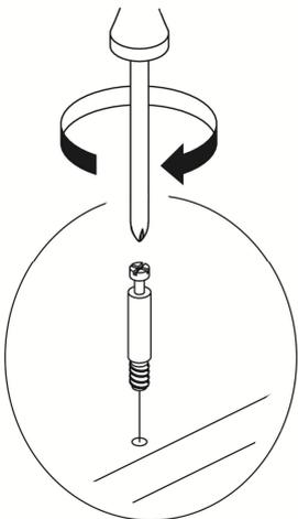
**Рис.6 - Установка и фиксация стяжки эксцентрика**
